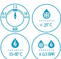
Nem ajánljuk a termostátos csaptelepet gáz vagy elektromos átfolyós vízmelegítővel használni.
