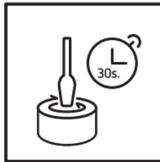
5. Usando la spatola mescolare energicamente i componenti per 30 secondi.
