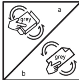
13. Das graue Papier auf den Block legen und den Schliff fertig bearbeiten (a). Im Falle einer abgerundeten Fläche das Papier ohne Block verwenden (b).
