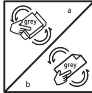
13. Legg et grått ark på blokken og avslutt sliping (a). På buede overflater bruk kun ark uten blokk (b).
