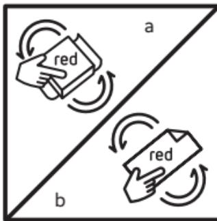
12. Nasad'te papír na kostku a červenou stranou přebruste opravované místo až k odstranění přebytku hmoty a získání rovného povrchu (a). U zaoblených povrchů použijte jen papír, bez kostky (b).
