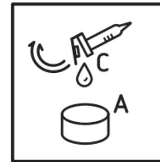
4. Åpne beholderen med herder. Forsiktig overfør innholdet til Gelcoat beholderen.
