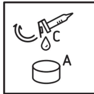
4. Öppna behållaren med härdare. Häll (härdaren) innehållet försiktigt in i gelcoatbehållaren.
