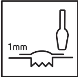
8. Een juiste hoeveelheid massa aanbrengen totdat men een laag van 1mm overshot krijgt boven de oppervlaklaag.
