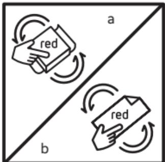
12. Nałóż papierek na kostkę i czerwoną stroną zeszlifuj miejsce naprawy do wyrównania z naddatku masy i do uzyskania równej powierzchni (a). W przypadku zaokrąglonej powierzchni użyj papierka, bez kostki (b).
