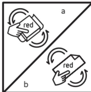
12. Das Papier auf den Block legen und mit der roten Seite die zu reparierende Stelle bis zum Ausgleich des Überschusses der Masse und Erreichen einer glatten Oberfläche abschleifen (a). Im Falle einer abgerundeten Fläche das Papier ohne Block verwenden (b).
