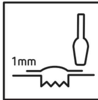
8. Aplicar una cantidad adecuada de la mezcla hasta llegar a un exceso de 1 mm sobre la superficie.
