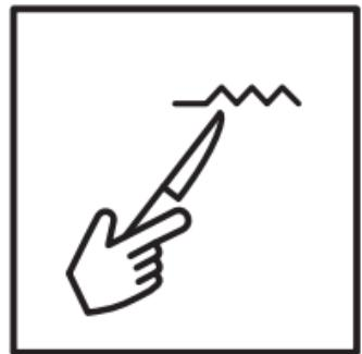
1. Rengjør det skadestedet med et skarpt verktøy for å fjerne rester av Gelcoat, støv og annen smuss.
