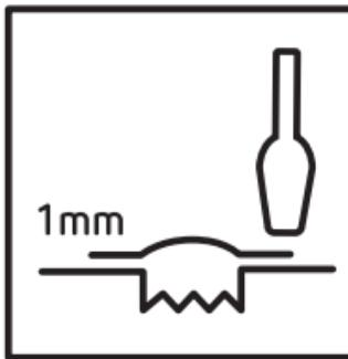
8. Naneste vhodné množství hmoty až k dosažení 1 mm přesahu nad povrchem.
