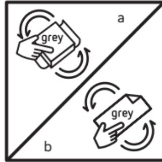
13. Lägg det gråa pappret på blocket och slipa ytan färdig (a). Om ytan är rund använd bara pappret, utan block (b).
