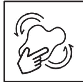
15. Appliquez la pâte sur le chiffon doux et avec des mouvements rotatifs, en appuyant, polissez la surface réparée.
