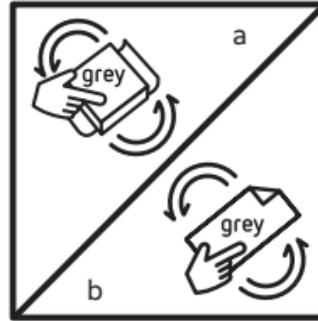
13. Doe het grijze papier op het blokje en maak het slijpwerk af (a). Gebruik bij een rond oppervlak alleen het papier, zonder het blokje (b).
