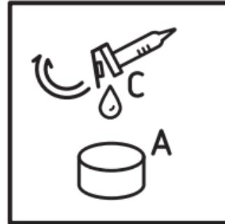
4. Avaa kovetesäiliö. Kaada huolellisesti kovete Gelcoat-säiliöön.
