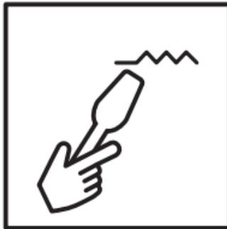
7. Mit der Spitze des Spatels die so vorbereitete Masse auf die defekte Stelle auftragen.
