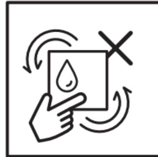
2. Die defekte Stelle mit entfettendem Mittel reinigen (z.B. Aceton, Alkohol).
