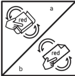
12. Doe het papier op het blokje en schuur met de rode kant de herstellingsplaats om het overschot aan massa gelijk te maken en een egaal oppervlak te krijgen (a). Gebruik bij een rond oppervlak papier zonder het blokje (b).
