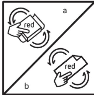
12. Lägg pappret på blocket och slipa defekta stället med röda sidan tills extra massan blir jämn på ytan (a). Om ytan är rund använd bara pappret, utan block (b).
