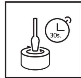
5. Usando la espátula mezclar energicamente los componentes durante 30 segundos.
