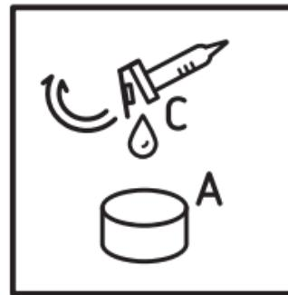
4. Otwórz pojemnik z utwardzaczem. Ostrożnie przelej zawartość do pojemnika z Gelcoat.
