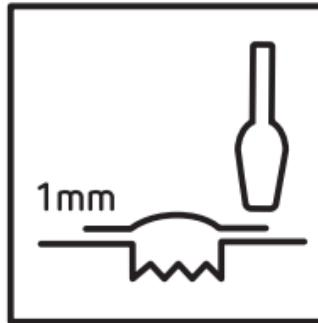
8. Entsprechende Menge der Masse auftragen, damit ein Überschuss von 1 mm über der Oberfläche entsteht.
