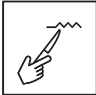
1. Mit dem scharfen Werkzeug die defekte Stelle reinigen, um die Reste des Gelcoats, den Staub und andere Verschmutzungen zu beseitigen.
